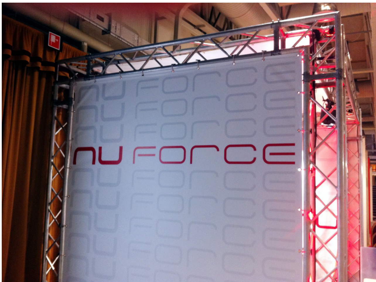
NU FORCE – allestimento stand con banner tensionati con elastici
