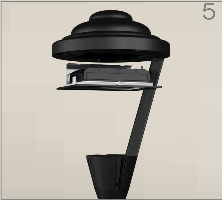
Collegare il filo elettrico al modulo led e avvitarlo al cappello
