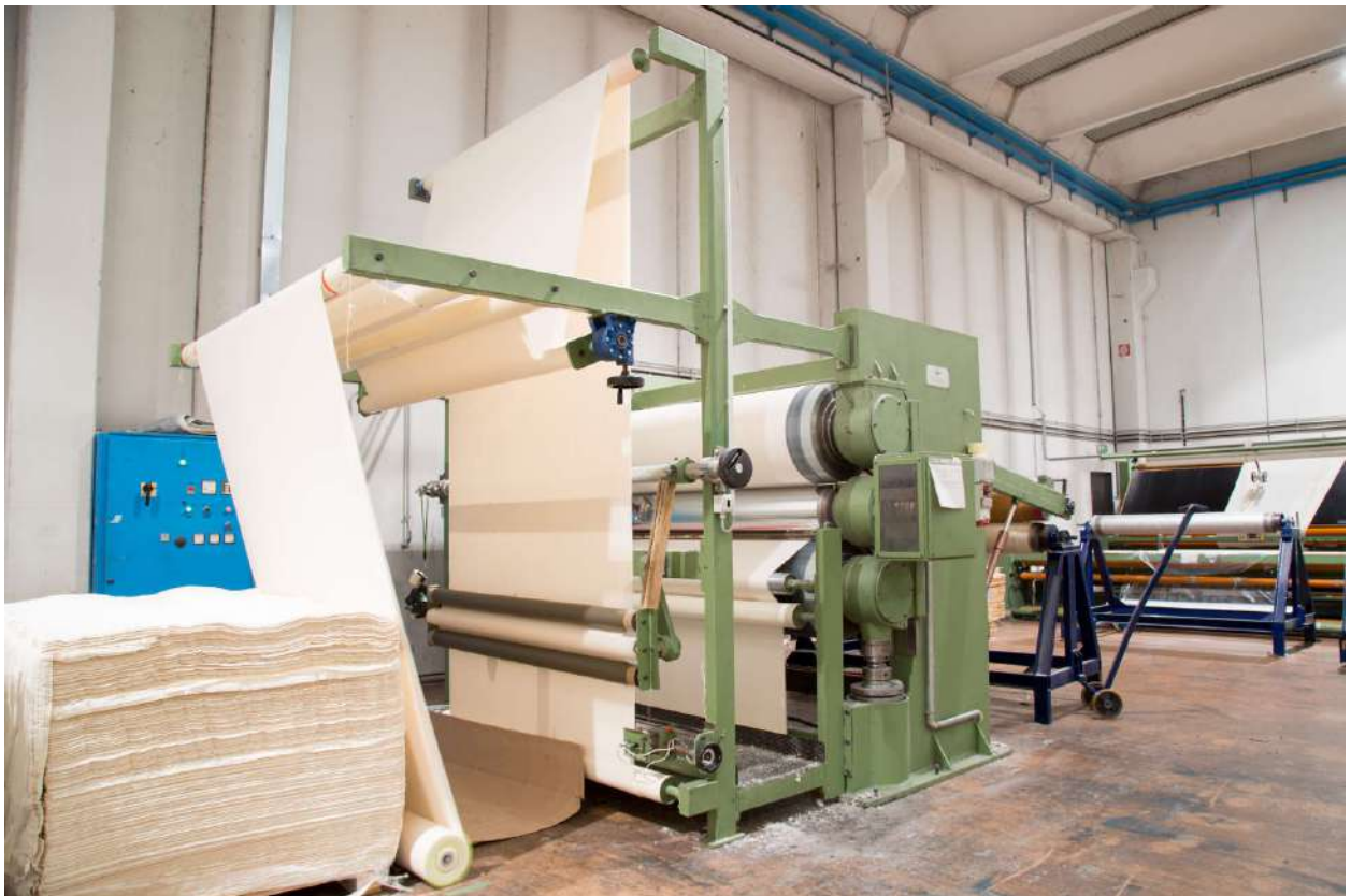
Calandratura del poliestere, azienda Texcene, Bergamo.
