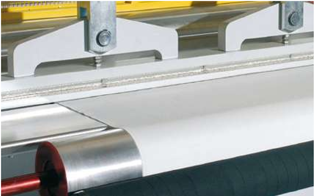
Termosaldatura, di un tessuto non definito, azienda Arrow, Vicenza.
