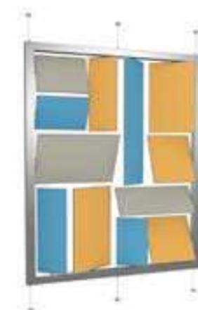
**2\_** Nel secondo caso è stato previsto un sistema di tiranti superiori ed inferiori per permettere al pannello di rimanere sospeso, senza il pericolo che possa oscillare.
