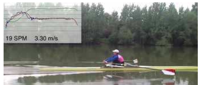
Fig. 70: Frame del video di sonificazione rowing motion. Analisi dell'accelerazione della barca, fasi della remata.
