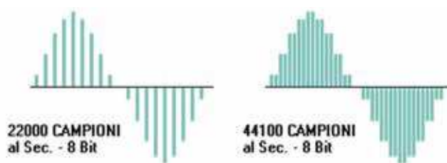
Fig 27: Due frequenze di campionamento a confronto. La prima ha una frequenza di campionamento bassa che distorce l'onda originale del suono (aliasing), la seconda ha una frequenza di campionamento alta che riesce a riprodurre perfettamente l'onda del suono originale
