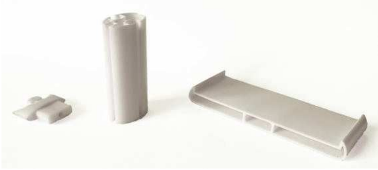
Sviluppo fisico, stampa 3d Studio delle geometrie per incastri e scorrimento degli elementi orizzontali
