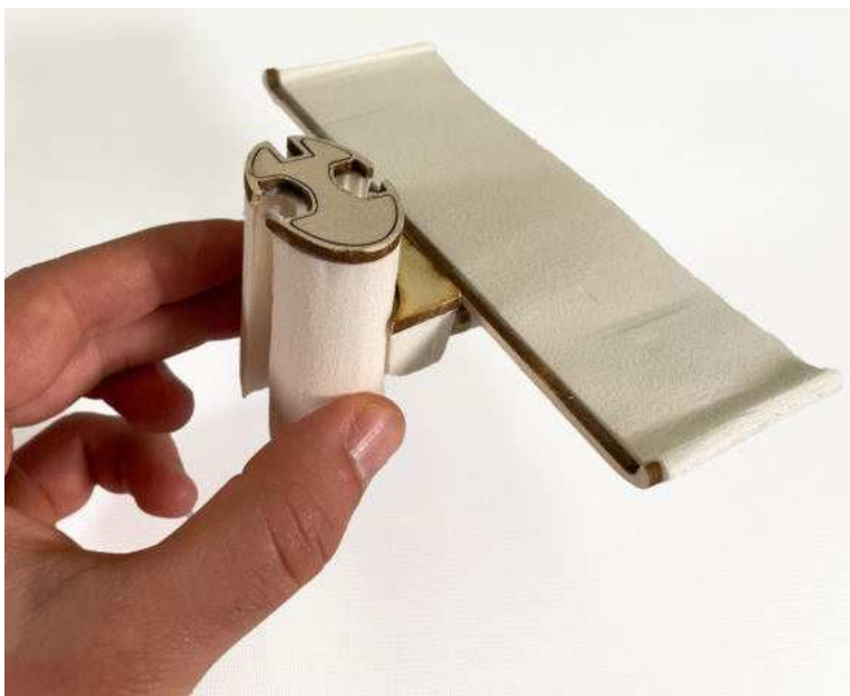
Sviluppo fisico, polistirolo e legno tagliato a laser Incastri dei tre elementi
