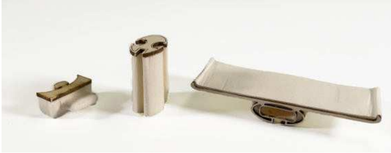
Sviluppo fisico, polistirolo e legno tagliato a laser Studio delle geometrie per incastri e scorrimento degli elementi orizzontali
