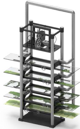
Vista ortogonale Multiplane Camera con le lastre di animazione
