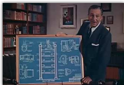
L'invenzione di Walt Disney Studio sulla Multiplane Camera usata per l'illusione tridimensionale.
