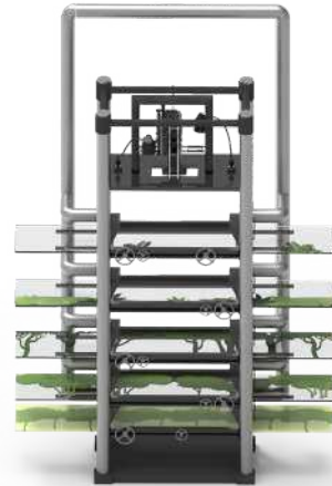
Vista ortogonale Multiplane Camera con le lastre di animazione
