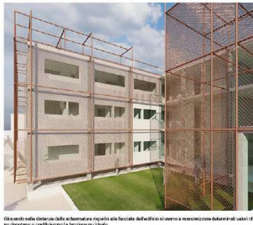
Giacendo sulle distanze della schermatura rispetto alle facciate dell'edificio si vanno a massimizzare determinati valori che ne determinano e costituiscono la funzione più ideale.
