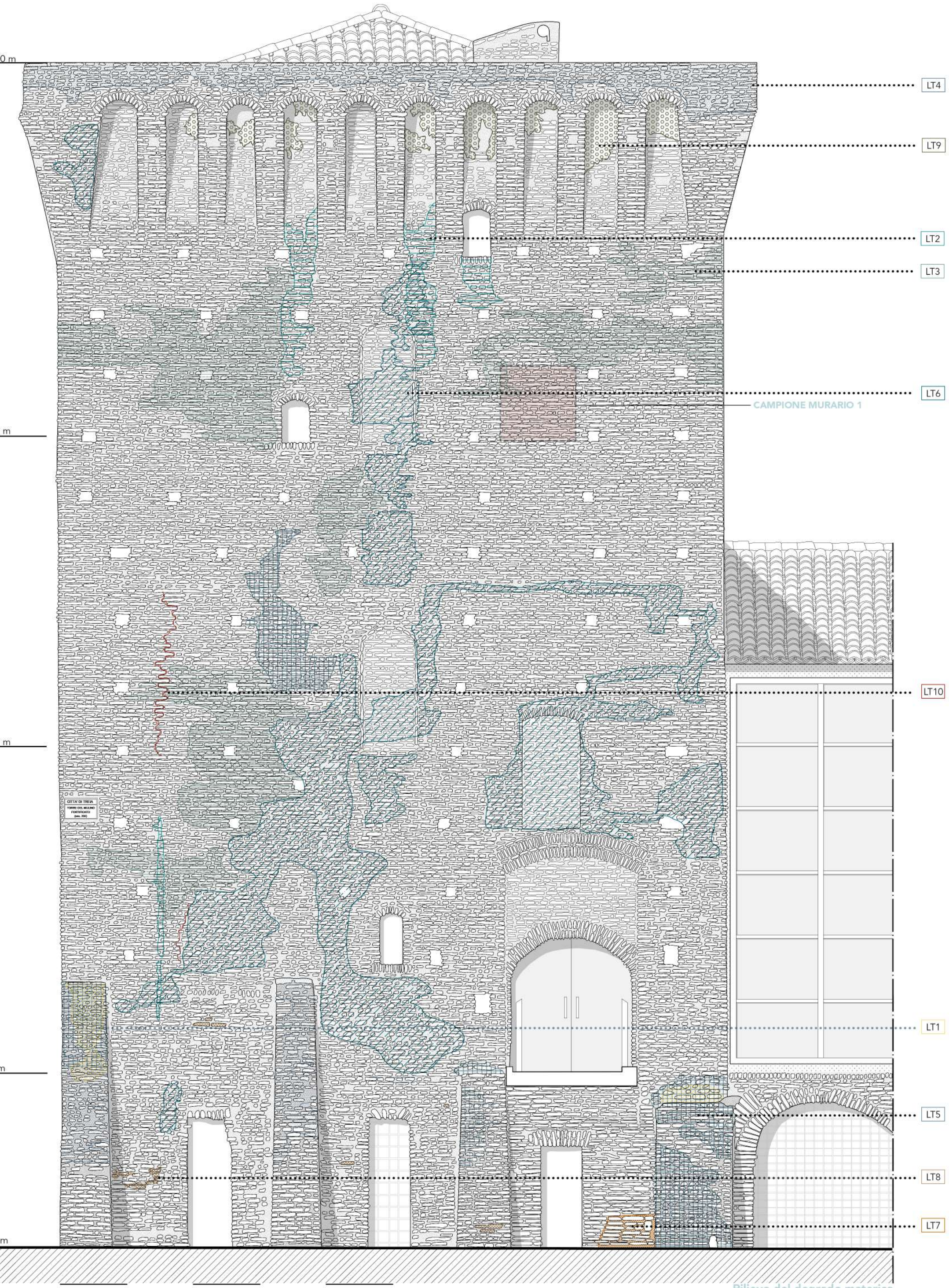
Rilievo del degrado murario Fronte EST
