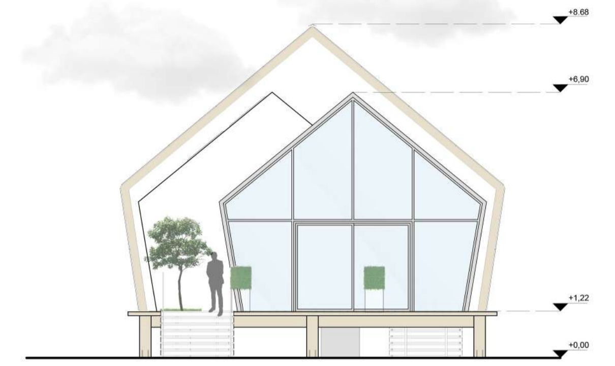
PROSPETTO OVEST SCALA 1:100
