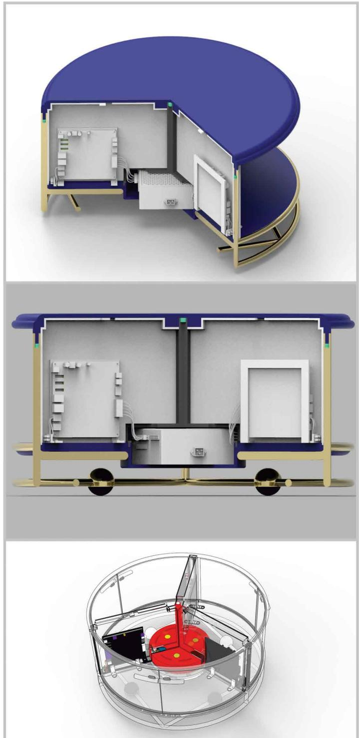
Il coperchio superiore è fissato con calamite (Figura.2) per consentire di toglierlo e sostituire i moduli a piacere in modo rapido.
