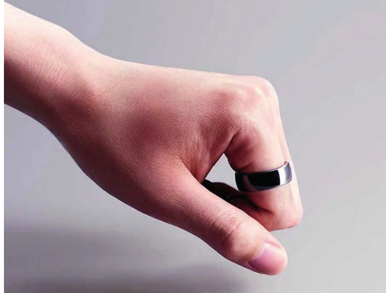
Fig. 34 Ringpay, McLEAR Ring. Anello in ceramica di zirconia. Funzione di pagamento contactless, 2020.
