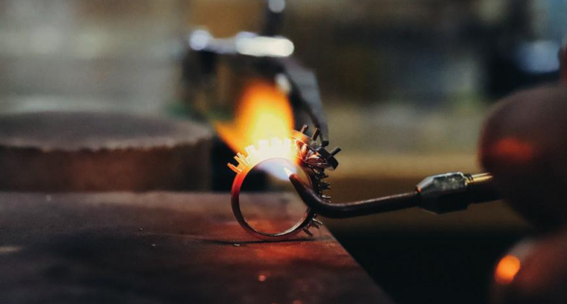
Fig. 24 Nella foto, le mani di un artigiano orafo mentre svolge il processo di saldatura.
