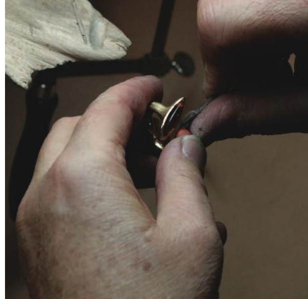
Fig. 26 Nella foto, le mani di un artigiano orafo mentre svolge il processo di incastonatura.
