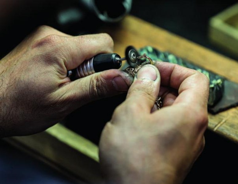
Fig. 25 Nella foto, le mani di un artigiano orafo mentre svolge il processo di lucidatura.
