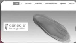
**GENSOLE** è uno strumento basato su browser che consente di progettare solette ottimizzate per la stampa 3D utilizzando il processo FDM e materiali di tipo Filaflex (TPE/TPU).
