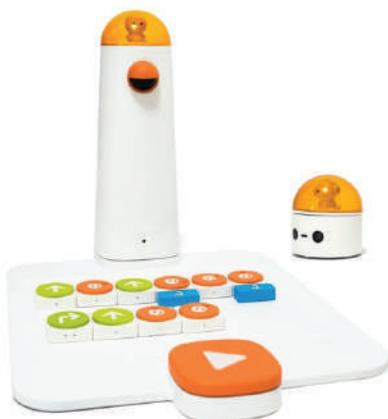
Figura 77- MatataBot (Robot e board di programmazione)
