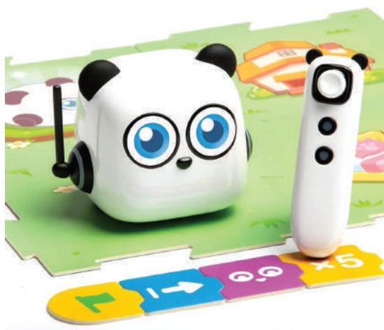
Figura 73- mTiny (Robot, carte codice e penna per la programmazione)
