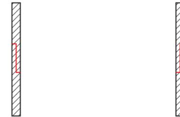
Per risolvere il problema è stato deciso di rimodellare l'oggetto in modo tale da creare degli spazi utili all'assemblaggio. **Per la precisione, applicando una tolleranza di 0.7mm sui pezzi in adiacenza/ad incasto.**
