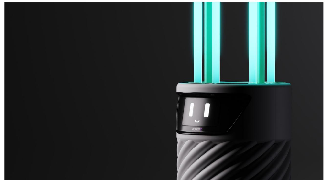
*processo di sanificazione dell'aria e delle superfici: le lampade UVC sono accese ed estratte*
