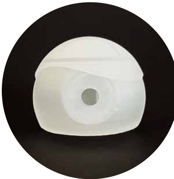
palpebra e occhio definitivi - simulazione espressioni del robot
