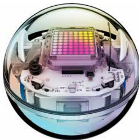
Scocca in policarbonato trasparente per la visione dello schermo e dei componenti
