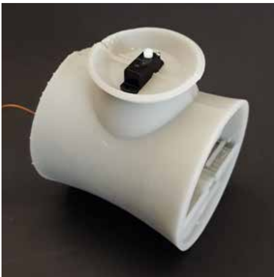
relazione servomotore-corpo - movimento occhio
