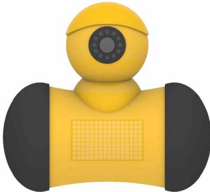
Inserimento di corona di LED attorno alla videocamera
