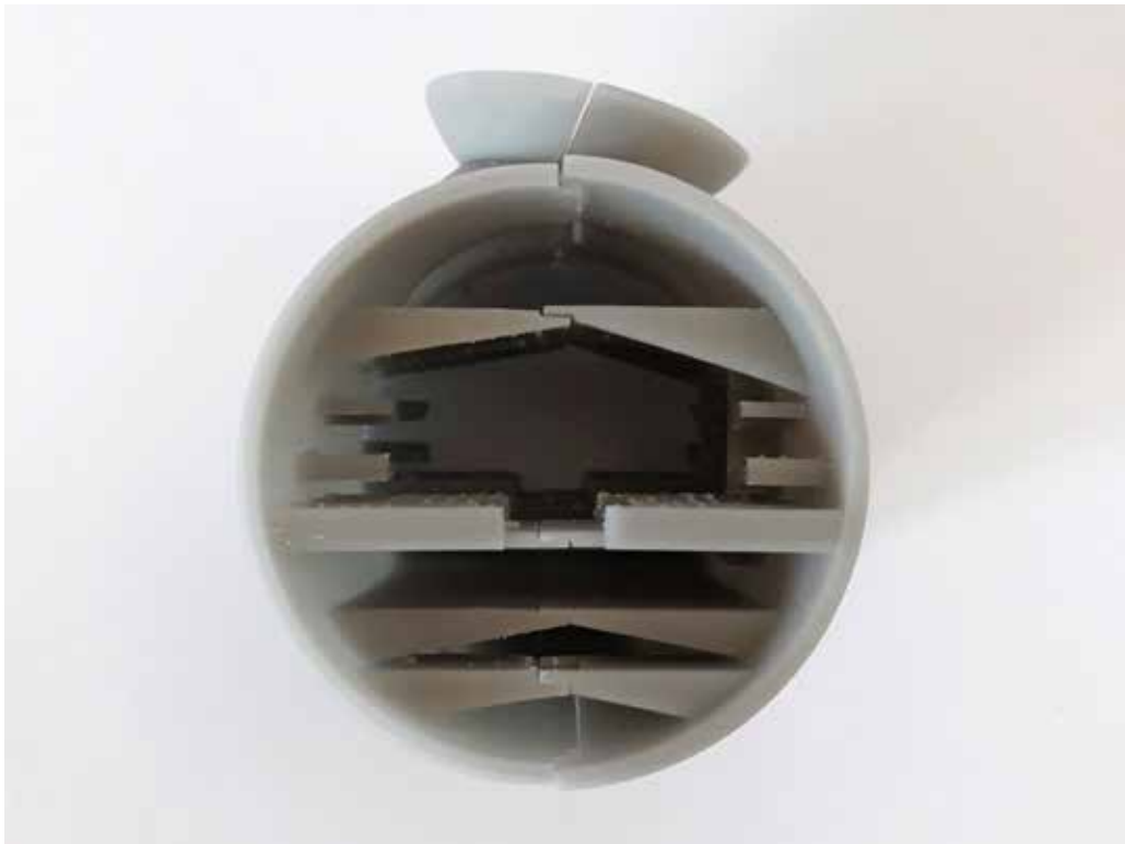
sezione posteriore e anteriore del corpo - rafforzamento dei supporti
