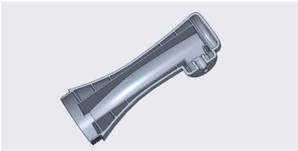
sezione manico modificata - inversione filettatura
