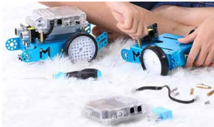
mBot in fase di montaggio
