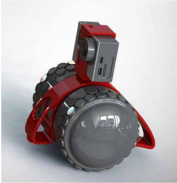
Ollie con elemento posticcio in plastica per sorreggere una GoPro
