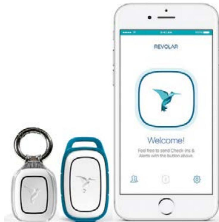
Questo dispositivo di sicurezza. Se premi due volte, Revolar invia un “avviso giallo” ai contatti preselezionati, ricevono un messaggio di testo con la posizione dell’utente e un messaggio che dice che l’utente si sente insicuro. Una tripla pressione invia un “avviso rosso” che indica che l’utente ha bisogno di un aiuto serio.<sup>41</sup>
