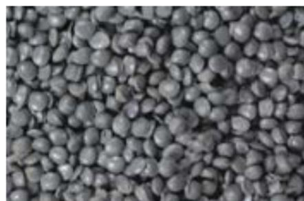
**Gomma di silicone** è un elastomero (materiale simile alla gomma) composto da silicone, esso stesso un polimero. Le gomme siliconiche sono ampiamente utilizzate nell'industria e esistono molteplici formulazioni. Le gomme siliconiche sono spessopolimeri a una o due parti e possono contenere riempitivi per migliorare le proprietà o ridurre i costi.
