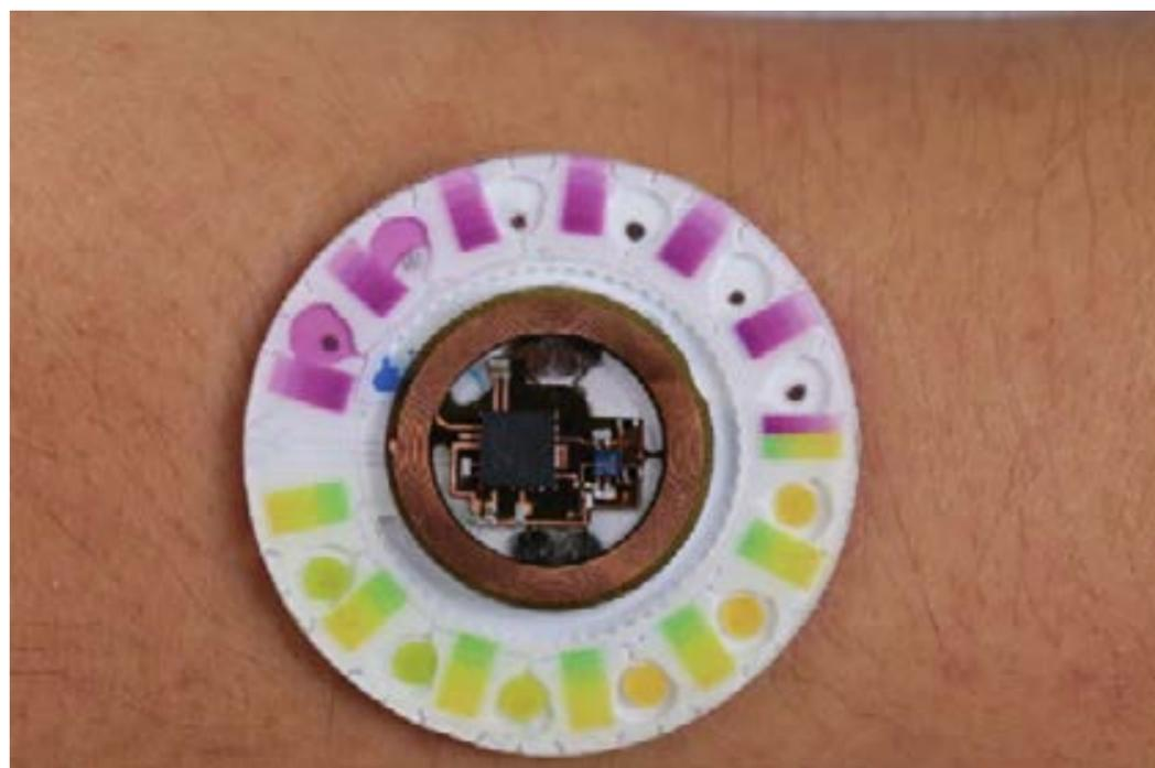
Fig. Sviluppato da un team internazionale di collaboratori, questo prototipo di sensore del sudore senza batteria può monitorare lattato, glucosio, cloruro, pH e velocità e perdita di sudore. Il sensore trasmette e riceve in modalità wireless i dati da e verso lo stesso telefono cellulare che lo alimenta tramite campo vicino.<sup>30</sup>
