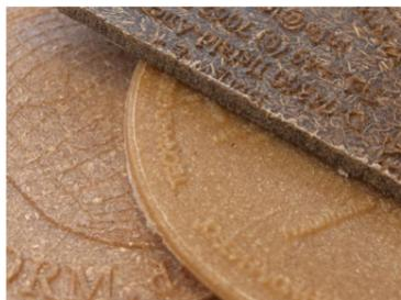
**Il Legno liquido** è una bioplastica composta ottenuta da tre componenti naturali: lignina, cellulosa e fibre di lino, canapa o altre piante, con l'aggiunta di additivi naturali. L'Arbofill è un tipo di legno liquido. L'Arbofill è l'ultimo materiale proposto da Tecnar, che però è composto da polimeri petrolchimici miscelati a fibre naturali. Questo prodotto è totalmente riciclabile e ha l'aspetto di un legno chiaro.
