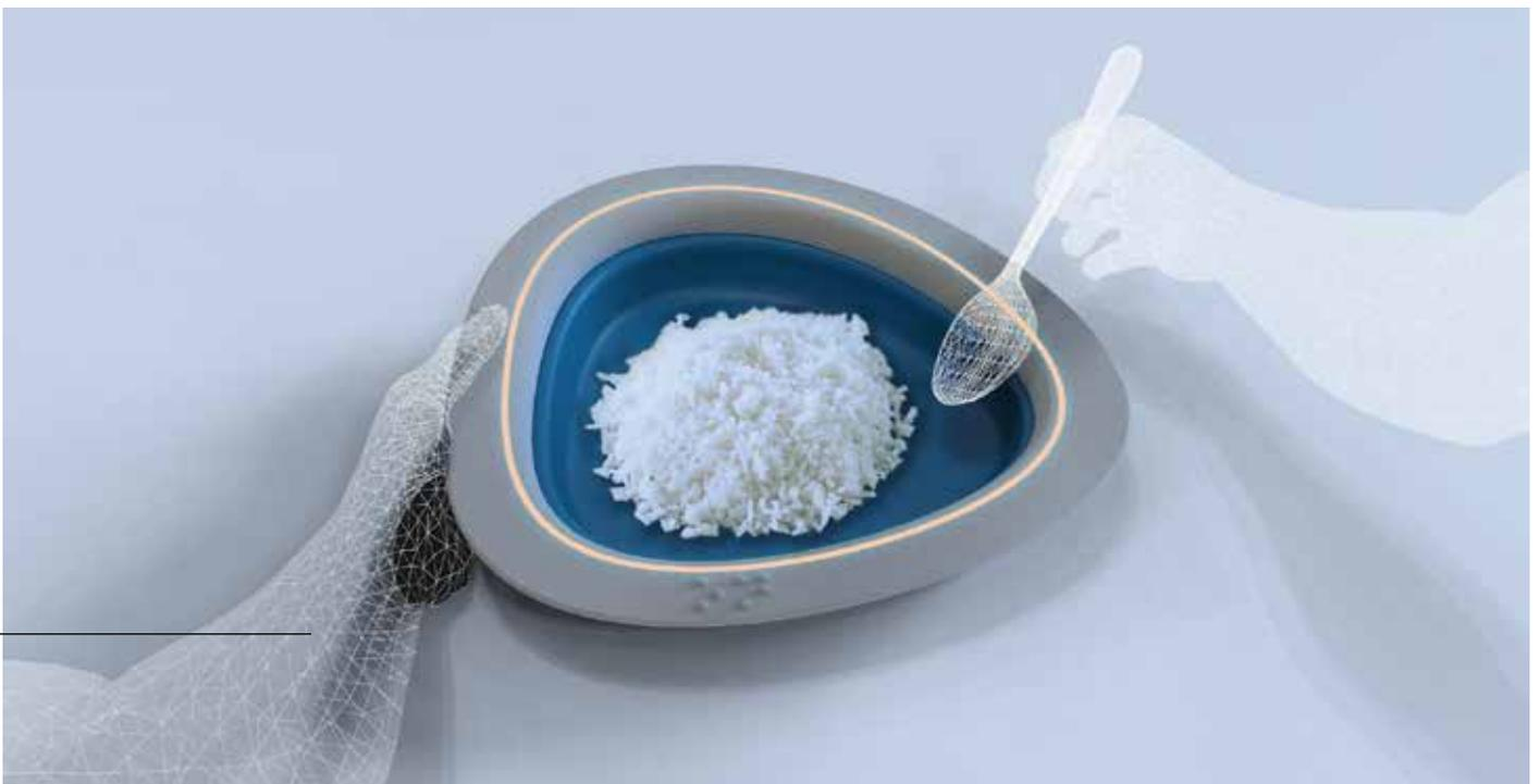
Una volta consumato una quantità di cibo, il dispositivo rileverà una peso minore in determinate aree, in questo caso nell'aria posta di fronte all'utente. Possiamo notare come il morphing, reso possibile dall'attuatore, crea un condizione di favorevole per raccogliere il cibo, visto che l'aria è minore quest'ultimo tenderà ad accumularsi. In questo caso si sono formati due sponde che permettono di raccogliere il cibo seguendo il bordo del piatto.
