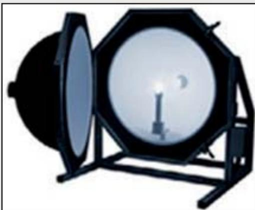
La misurazione viene effettuata per mezzo di una cellula fotovoltaica posta dietro una piccola fessura praticata sulla superficie della sfera e per evitare che la cellula riceva direttamente i raggi luminosi emessi dalla sorgente,
