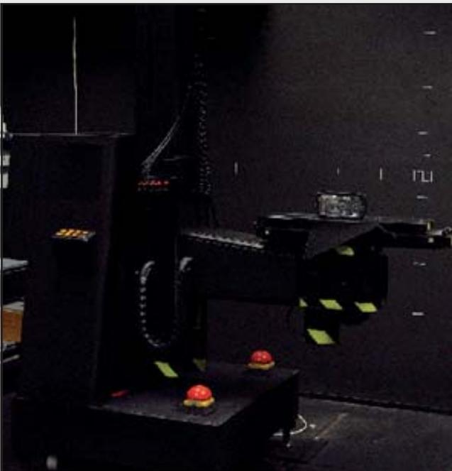
Il metodo classico avviene tramite misure di laboratorio. Uno dei metodi utilizzati consiste nel fissare la sorgente o apparecchio luminoso su una tavola rotante posta in asse con un rilevatore situato ad una certa distanza ed entrambi collegati ad un computer. La tavola viene ruotata lungo i due assi e ad ogni rotazione viene misurata l'intensità luminosa. Una volta raccolti tutti i dati questi vengono
