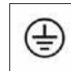
La **classe isolamento I** contrassegna apparecchi da collegare a un conduttore di protezione.
