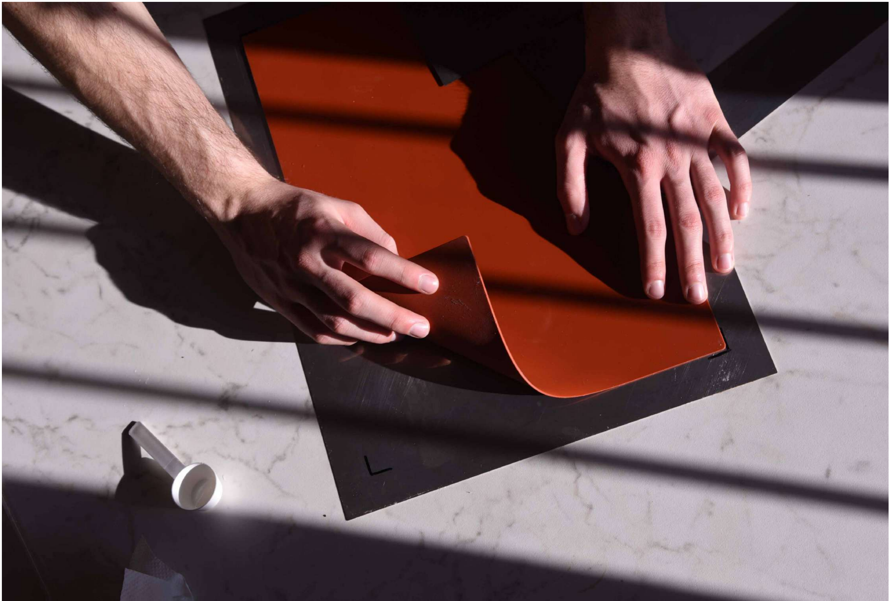
Preparazione della maschera in lamiera con tappetino in silicone
