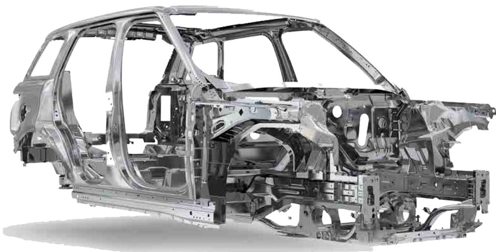
Struttura Integrated Bodyframe di una Range Rover. Sono ben visibili nella parte anteriore i due longheroni del telaio paralleli al senso di marcia.
