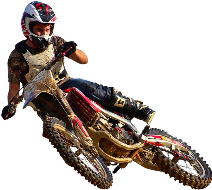
Moto da cross moderna durante un salto. Sono molto evidenti nella parte bassa le due travi inferiori del telaio a doppia culla.
