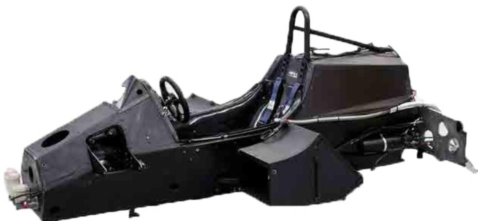
Monoscocca in carbonio della McLaren MP4/1 (1981). Fu la prima vettura equipaggiata con questo tipo di telaio a partecipare al Mondiale di Formula 1 nella stagione 1981. Dietro la schiena del pilota possiamo vedere il serbatoio integrato nel monoscocca che finisce poi tronco; in quel punto si aggancia il motore con funzione portante che sorregge cambio e sospensioni posteriori.
