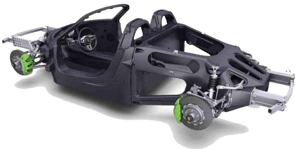
Telaio Porsche monoscocca in fibra di carbonio. Sono evidenti il dispositivo di sicurezza per gli urti posteriore e il sottotelaio anteriore per alloggiare organi meccanici e sospensioni
