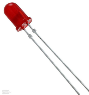
Esempio di LED a Tecnologia THT
