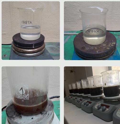
La polimerizzazione inizia aggiungendo il catalizzatore (cloruro stannoso) all'acido lattico con una percentuale di 0,6 g ogni 100ml di acido; successivamente si posiziona il composto su una piastra riscaldante a  $180^\circ$  per circa tre ore. L'acido in questo frangente cambierà colore virando dal trasparente fino ad un color ambra opaco. La reazione sarà ultimata quando raffreddando il materiale rimarrà solido e rigido, simile al vetro.
