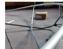
Connessione dello steccone con il terminale dell'ala: esso avviene tramite un tubicino in acciaio che ospita parte dello steccone
