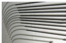
Tubolare laterale che funge da ala che ha diametro di 44mm. Lung. 2390 mm e raggio curvatura 2530 mm.
