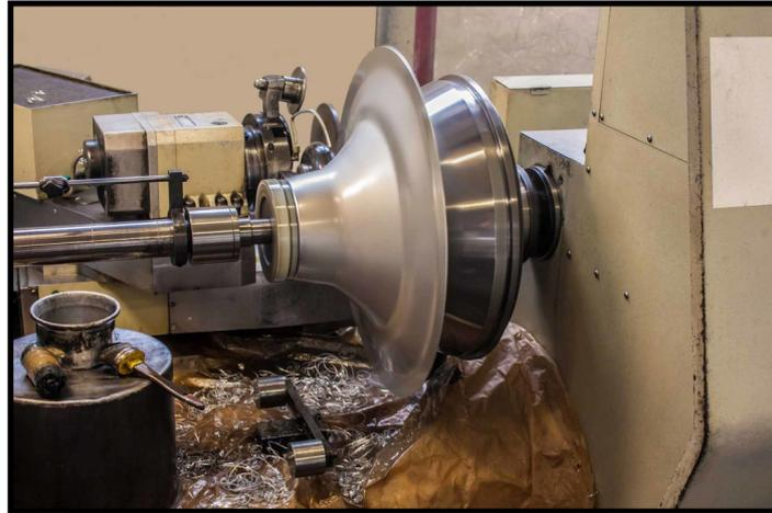
Il tornio è il macchinario che permette la deformazione di una lamiera fino ad ottenere manufatti a simmetria assiale.
