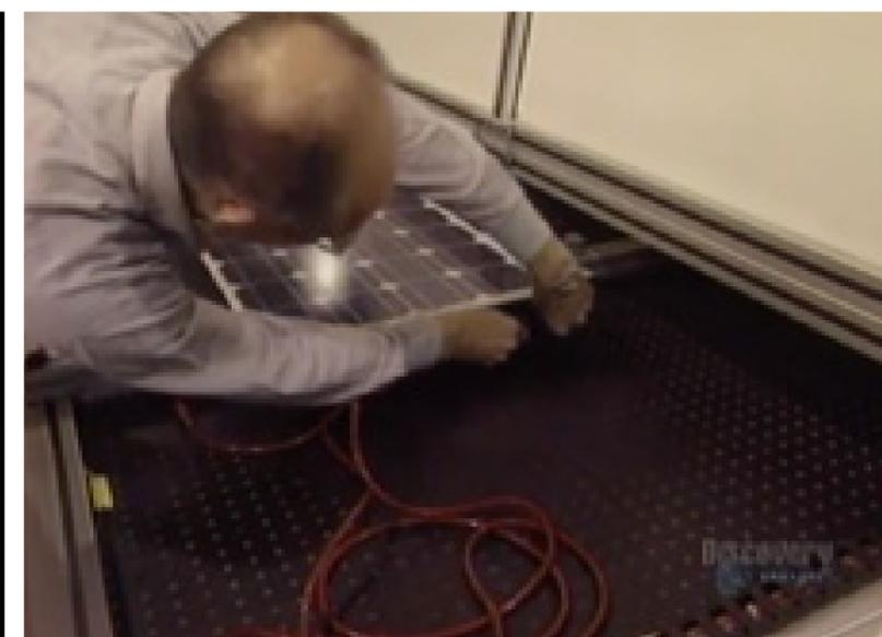
I poli positivi e negativi vengono collegati ad un voltmetro e si effettua la simulazione attraverso un apparecchio che ricrea la luce solare.
