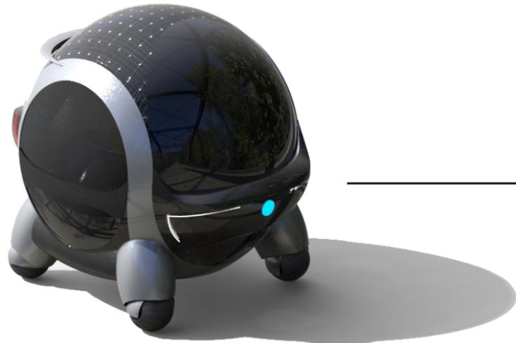
Essendo un veicolo totalmente elettrico e non avendo un unico motore che trasmette moto alle ruote, bensì un motore per ogni ruota, gli assiemi e i sistemi che, di norma, troveremmo su una normale autovettura, qui sono assenti.
