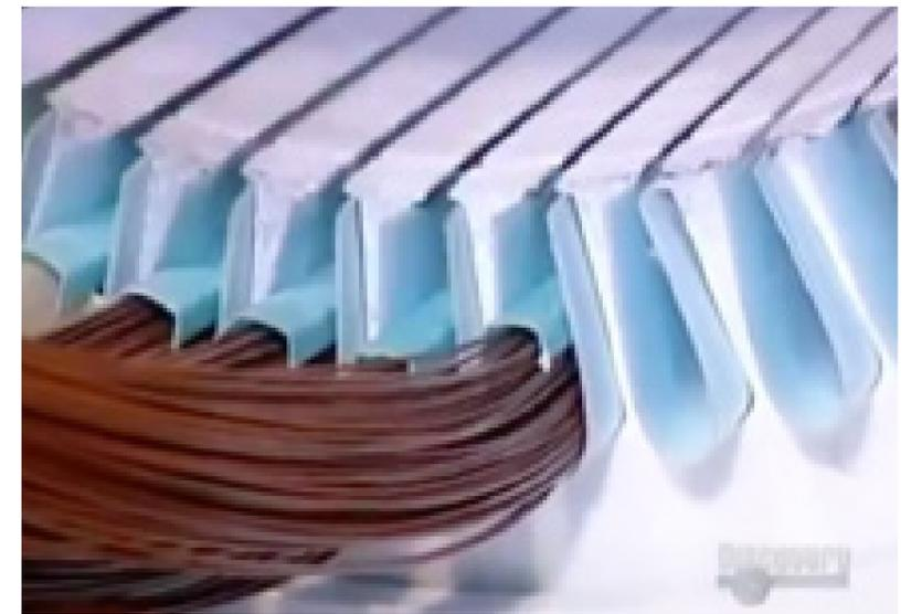
Quando tutte le serpentine sono state applicate e isolate, si inizia la **preparazione della connessione** facendo scorrere un manicotto di **isolante acrilico** sulle estremità di ogni serpentina.
