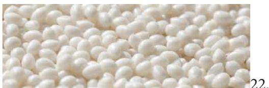
Bioplast è un materiale biodegradabile a base di fecola di patate che può essere utilizzato per estrusione o stampaggio ad iniezione. Dopo il suo utilizzo, il materiale viene reintegrato nel ciclo biologico. Applicabile in particolare al settore degli imballaggi industriali.
