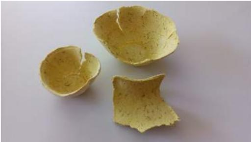
Quantità eccessiva di fecola e spessore troppo sottile causano rottura del prodotto
