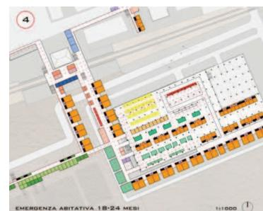
Il progetto è partito dalla dimensione del modulo base di altezza 3,2m x 1,6 m x1,6 m per facilitarne il trasporto. Anche la scelta dei materiali è stata motivo di studio: i moduli hanno un'anima resistente in acciaio e sono rivestiti in policarbonato alveolare che insieme all'isolante termico acrilico dona una leggera trasparenza all'elemento permettendo il passaggio della luce all'interno dell'abitacolo.
