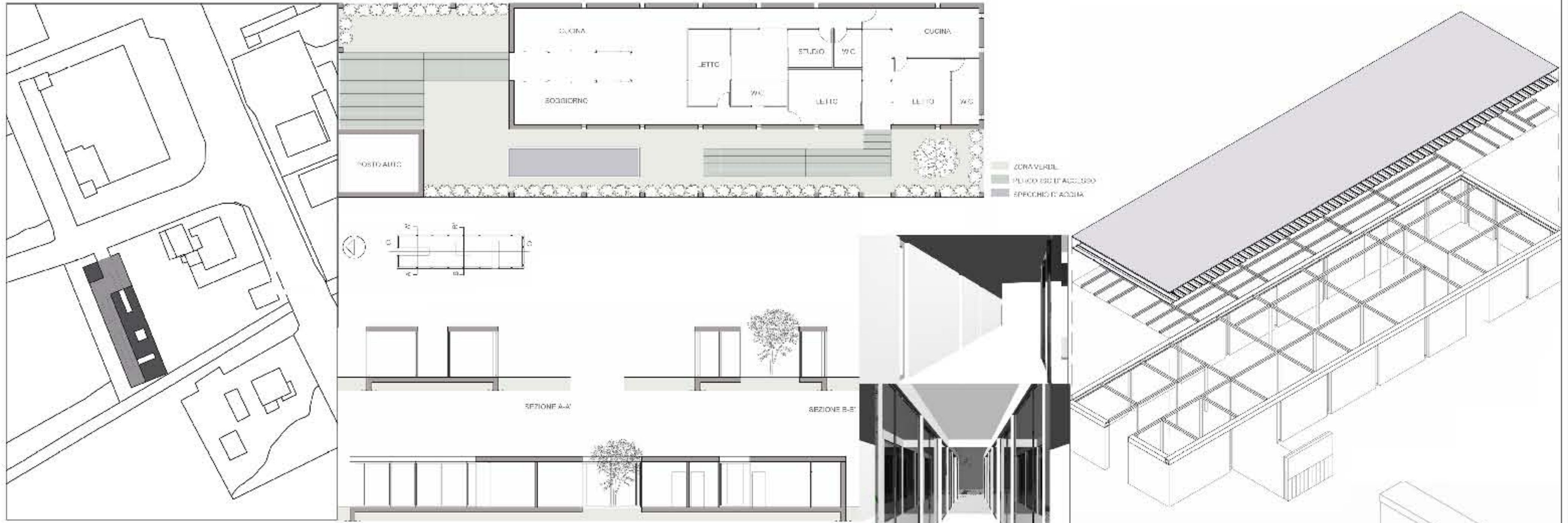
LABORATORIO DI PROGETTAZIONE DEI SISTEMI COSTRUTTIVI: Progetto struttura interamente assemblata a secco. Prof. Sonia Calvelli.
