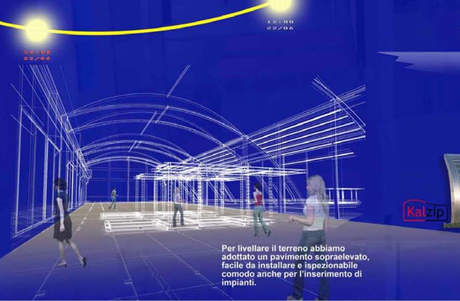
Per livellare il terreno abbiamo adottato un pavimento sopraelevato, facile da installare e ispezionabile comodo anche per l'inserimento di impianti.
