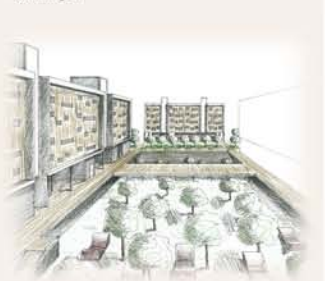
Blind solari Sistema di schermatura scorrevole con struttura in alluminio e listelli in legno.
