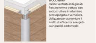
WOODWRAP Parete ventilata in legno di frassino termo trattato con sottostuttura in alluminio pressopiegata e verniciata. Utilizzato per aumentare il livello di efficienza energetica e qualità ambientale.
