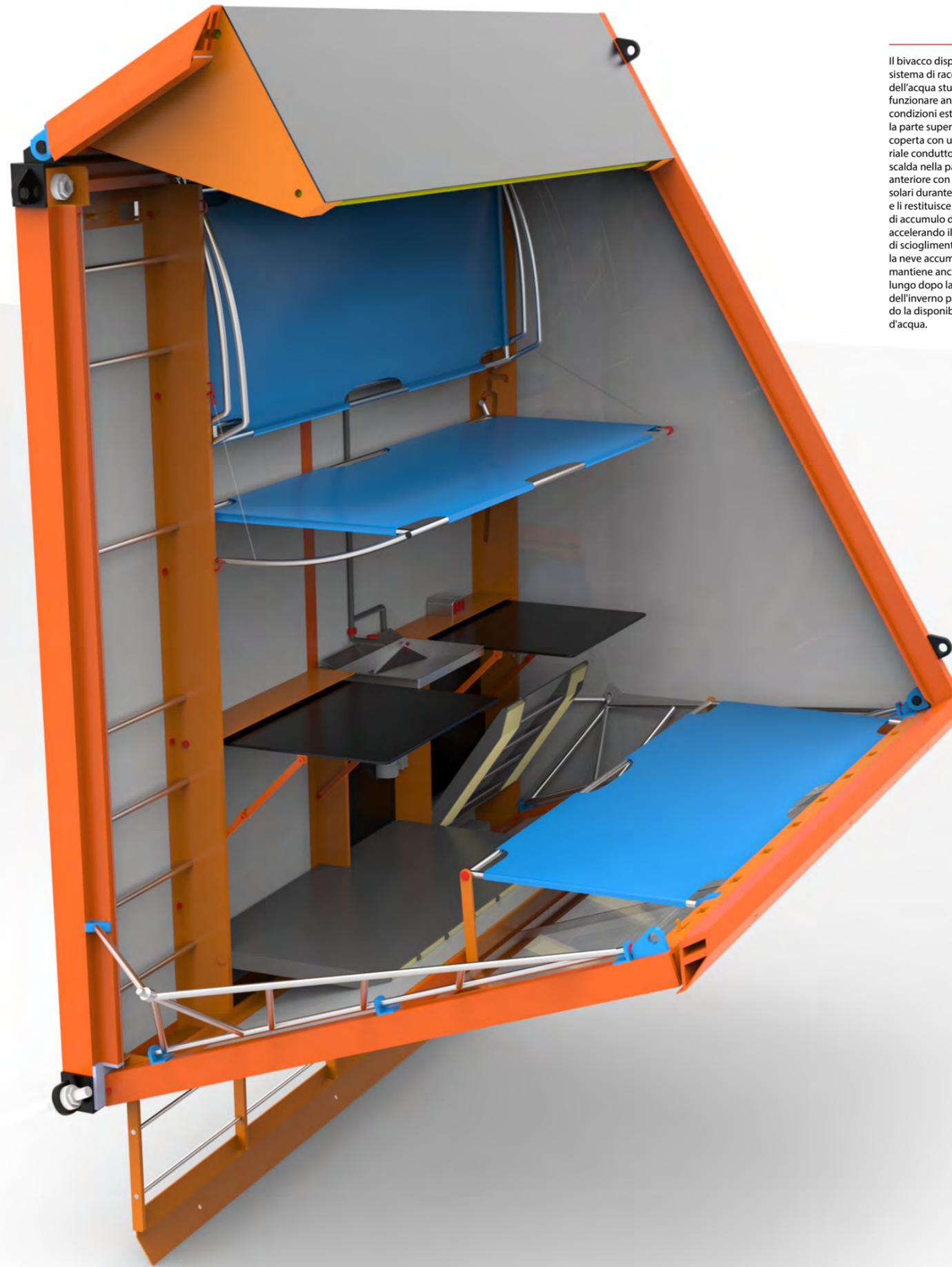
Il bivacco dispone di un sistema di raccolta dell'acqua studiato per funzionare anche in condizioni estreme. la parte superiore è coperta con un materiale conduttore che si scalda nella parte anteriore con i raggi solari durante il giorno e li restituisce sul fondo di accumulo della neve accelerando il processo di scioglimento. la neve accumulata si mantiene anche più a lungo dopo la fine dell'inverno prolungando la disponibilità d'acqua.
