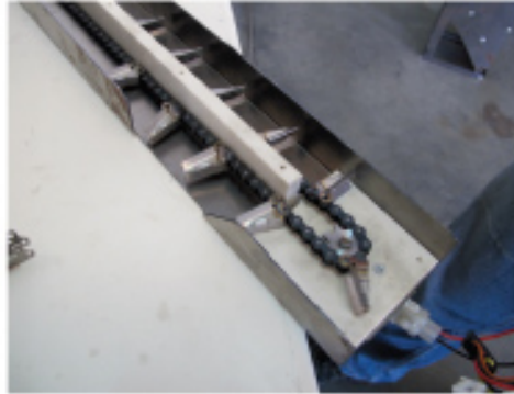
Realizzato in officina con lamiere INOX tagliate a laser e successivamente piegate; spessori in polimero. Carica a passo metrico da 8 mm.
