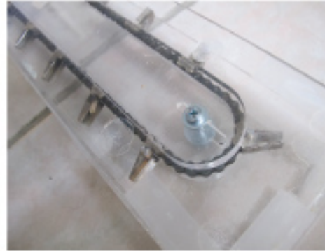
Catena del secondo prototipo montata in un guscio di plexiglas. Il pignone folle è stato sostituito da una guida.
