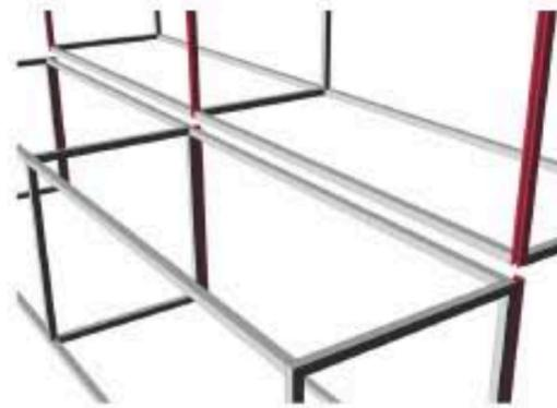
La struttura portante è formata da tubi in acciaio, ad incasto maschio-femmina in modo da reggere la struttura leggera, facile da trasportare a seconda del luogo dove se ne ha più bisogno
