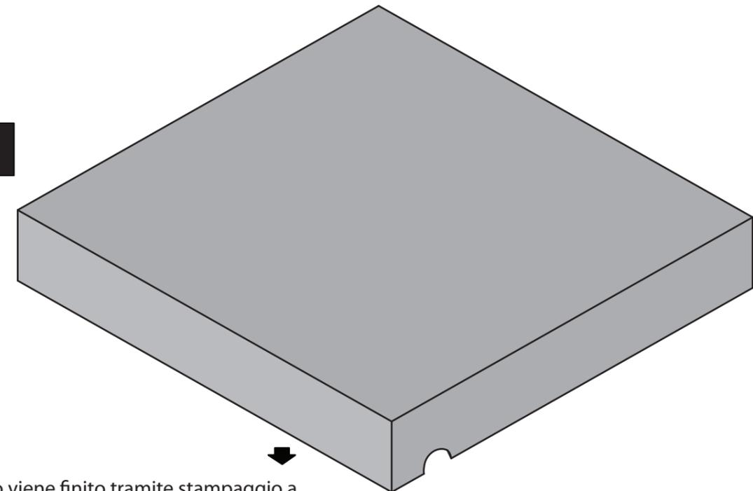
Il corpo semirigido viene finito tramite stampaggio a iniezione. In questo modo il silicone ricopre anche la parte superiore del pezzo lasciando una cavità al centro.
