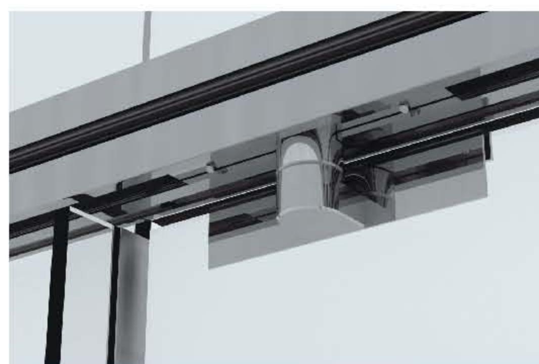
Particolare della cerniera superiore ancorata al profilo in alluminio.
