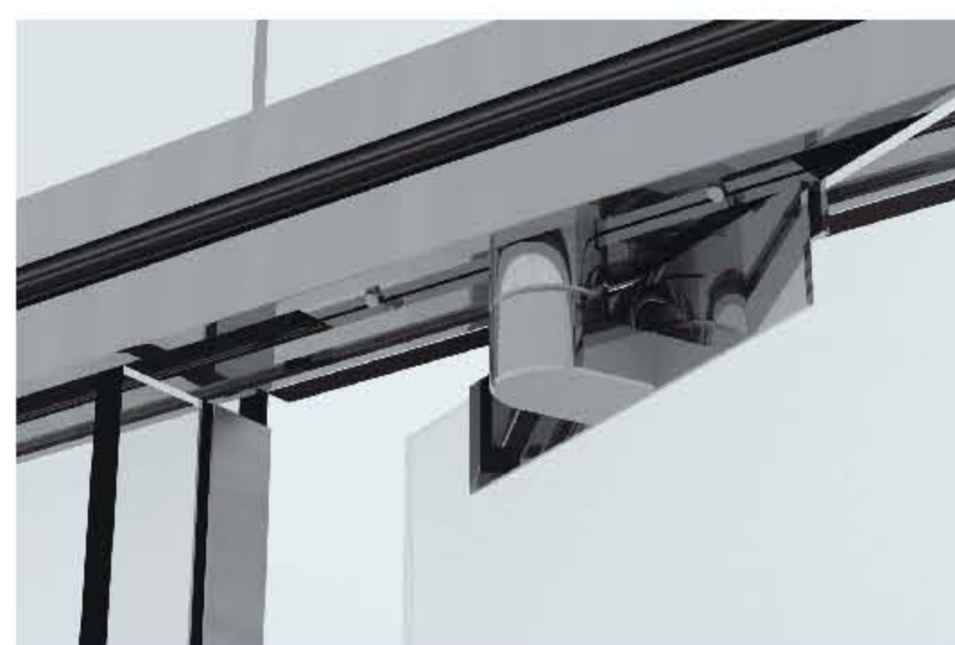
Particolare della cerniera superiore con anta in apertura.
