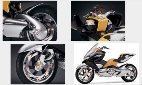
Honda Griffon, concept del 2003 La Honda compie una fusione fra una motocicletta e uno scooter. La particolarità di questo prototipo è di aver posizionato i portacassi nella parte anteriore, anziché sotto il sedile, potendo così permettersi un codino molto motociclistico.
