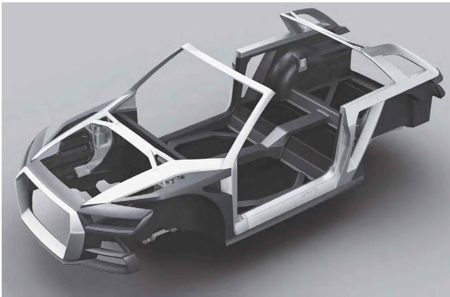
più componenti e funzionalità possibili. Al contrario, l'approccio multimateriale se vogliamo torna leggermente indietro, risultando più simile ad un concetto di body-on-frame, ovvero di una scomposizione del veicolo nei vari componenti, assemblandoli tra loro, ma senza stravolgere la struttura tipica della vettura.
