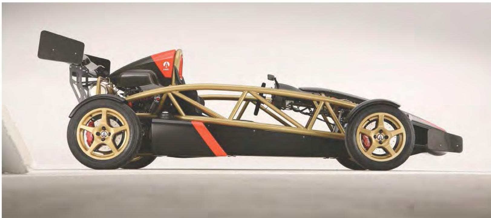
vettura, con il motore immediatamente dietro le spalle del pilota, e la carrozzeria è di tipo barchetta, senza quindi nessun parabrezza, nè tetto a proteggere l'individuo dall'ambiente esterno: il compromesso a favore del comfort è totalmente assente. Sul muso è possibile trovare un piccolo scomparto per una borsa e un casco, che agisce anche da attutitore in caso di impatto frontale.
