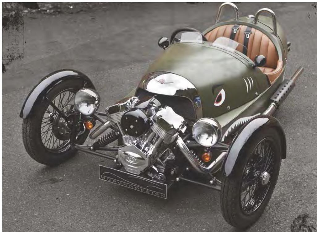
tubolare in acciaio, con alcuni elementi stressati realizzati utilizzando legno di frassino, e una carrozzeria completamente in alluminio, che prende ispirazione dalle carlinghe degli aerei da combattimento inglesi.
