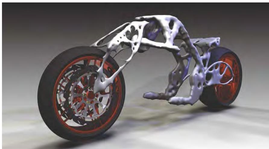
Il risultato dell'ottimizzazione è un modello tridimensionale per poligoni, che definisce delle strutture risultanti dall'applicazione dei carichi.
