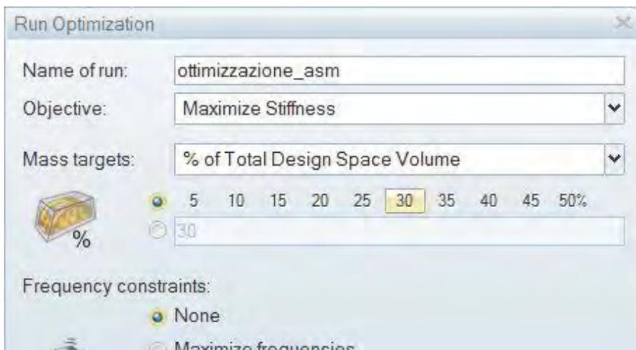
A questo punto l'ultimo passo prima di lanciare il processo è quello di impostare i parametri desiderati in fase di calcolo. Il primo valore è la percentuale di materiale desiderato al termine dell'ottimizzazione. Lasciamo il valore standard del 30% in quanto non abbiamo necessità particolari in questo senso, e valori minori potrebbero generare geometrie aperte a causa della mancanza di materiale.
