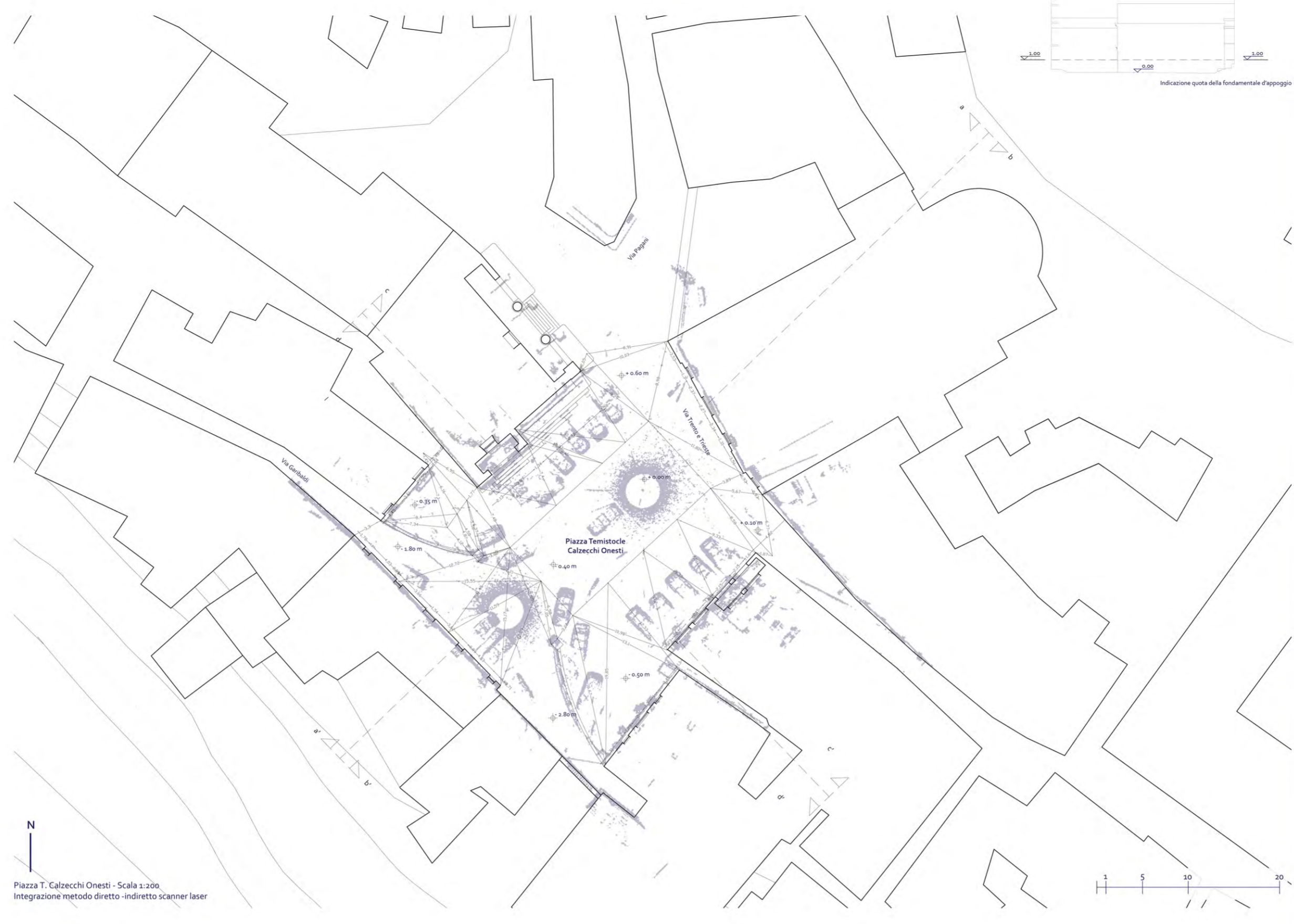
Piazza T. Calcezchi Onesti - Scala 1:200 Integrazione metodo diretto-indiretto scanner laser
