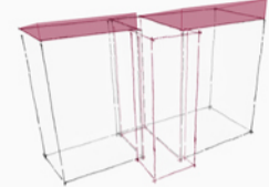
Nuova copertura ad una falda
