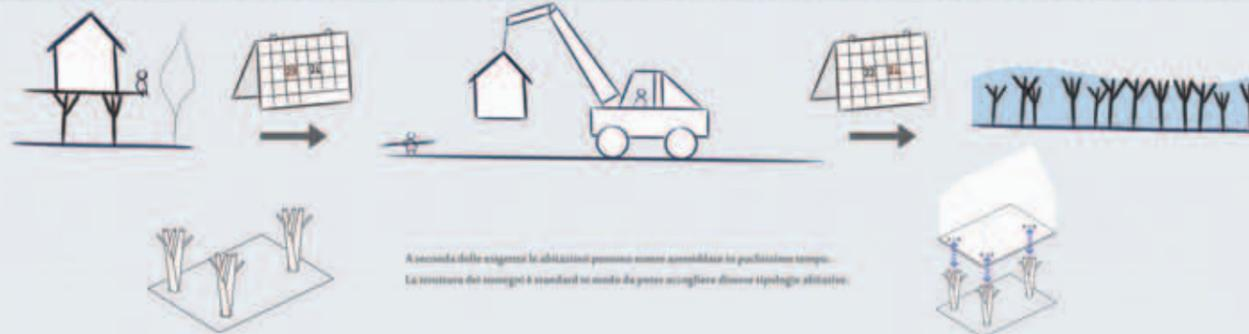
A seconda delle esigenze le abitazioni possono essere assemblate in pochissimo tempo. La struttura dei singoli è standard in modo da poter accogliere diverse tipologie abitative.
