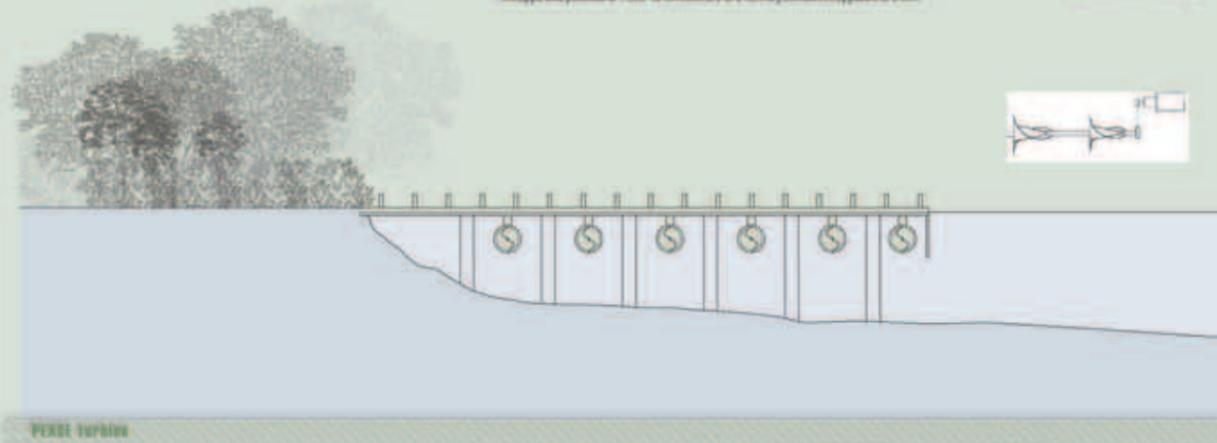
La Peace Turbine è una turbina progettata per funzionare in correnti d'acqua, senza la necessità di costruire di un altro piccolo essere installare singolarmente o in serie sullo stesso asse. Inoltre possono essere installate "in cascata" sullo stesso corso d'acqua ad una distanza che dipende dalla velocità della corrente stessa.
