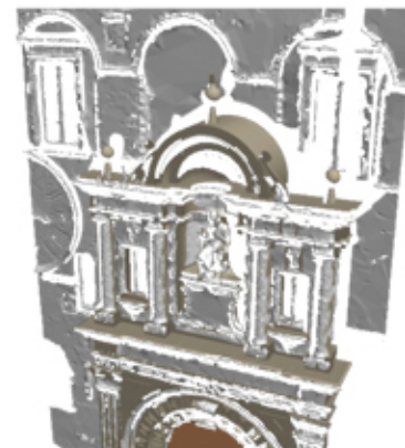
Prova di comparazione tra la nuvola di punti e il modello BIM.
