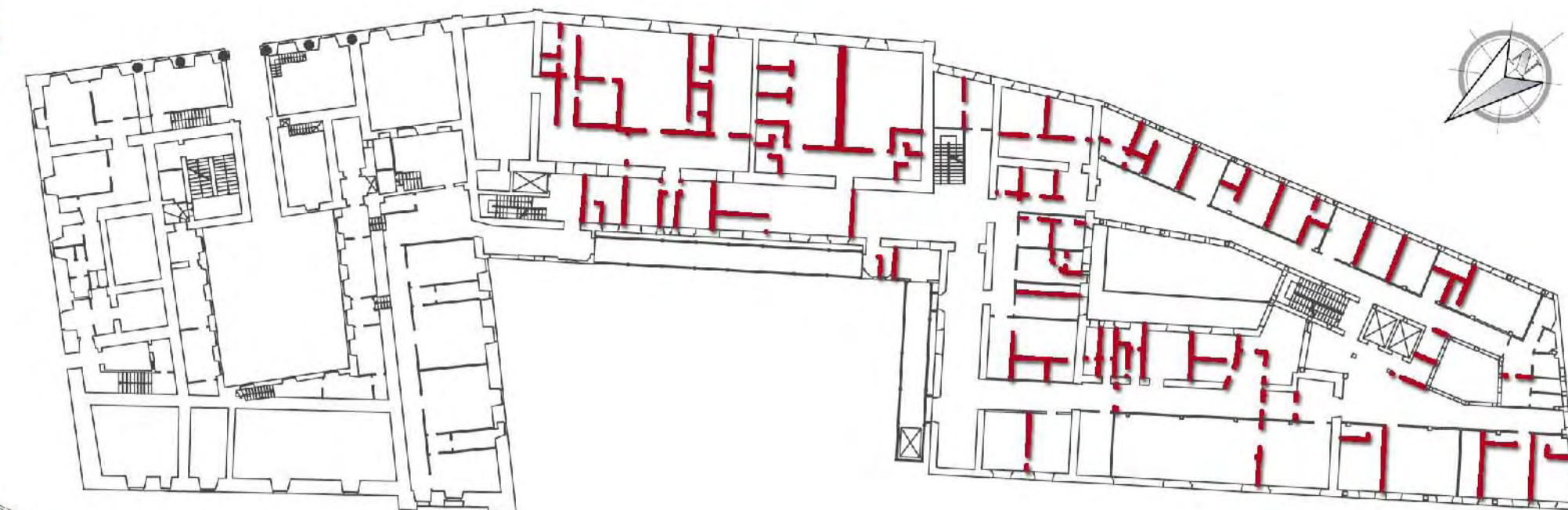
Pianta delle demolizioni del primo piano scala 1:500
