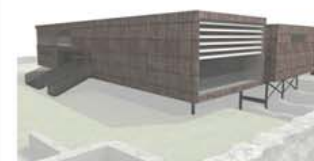
4. Il volume nella parte della sala convegni, non presenta finestre ai lati e quindi l'unica fonte di luce si trova all'interno del gradone ed una parete vetrata per di più accessibile verso la loggia esterna.
