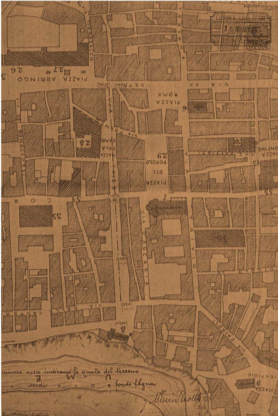
Figura 6: 1928, planimetria comunale della Gran Via con segnate le quote di profondità dell'arteria fognaria.
