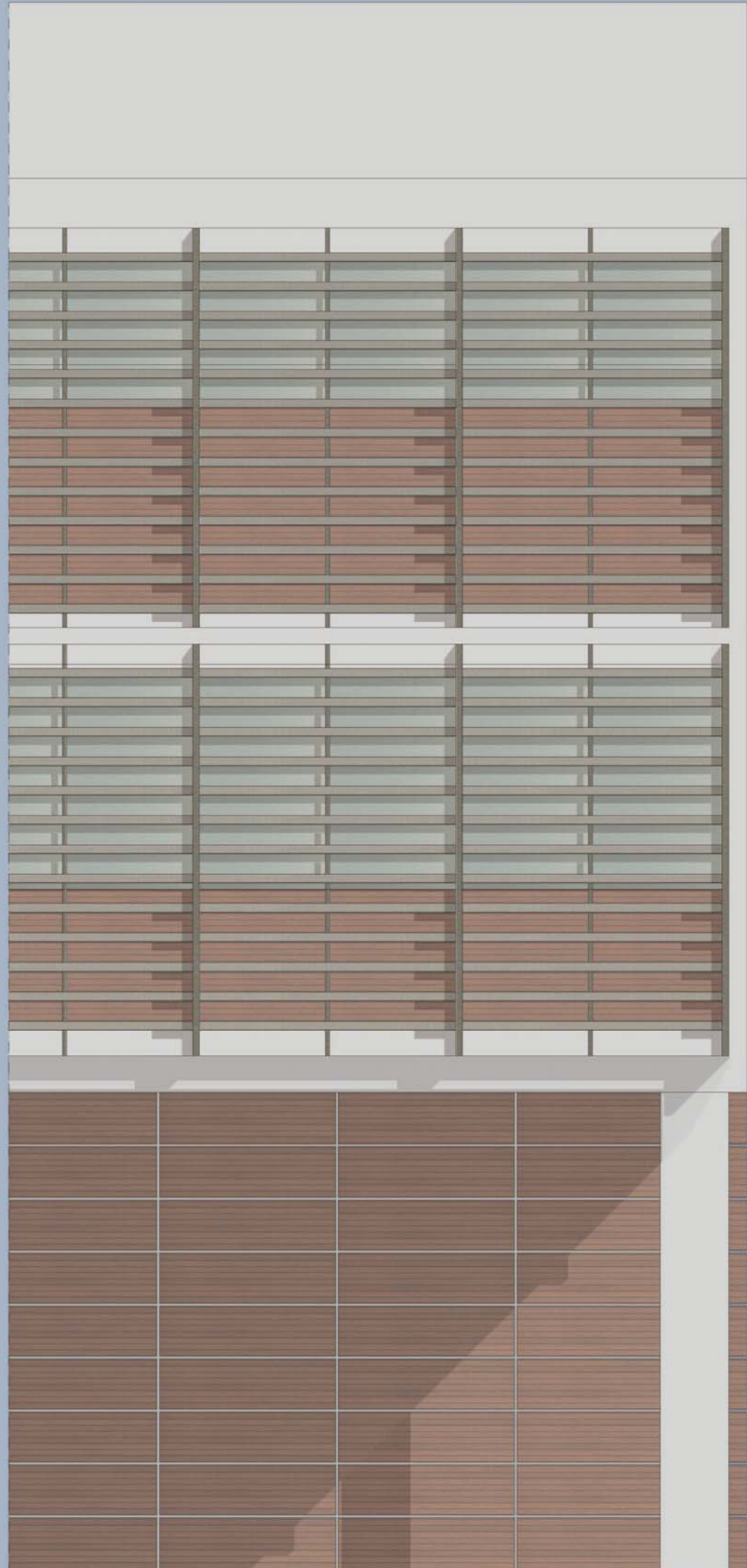
dettaglio facciata - sezione verticale e prospetto - scala 1:20
